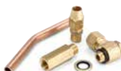
13 Kit di tropicalizzazione, da usare quando la temperatura dell'acqua in ingresso supera i 25 °C o la portata dell'acqua in uscita è inferiore a 5 l/min
