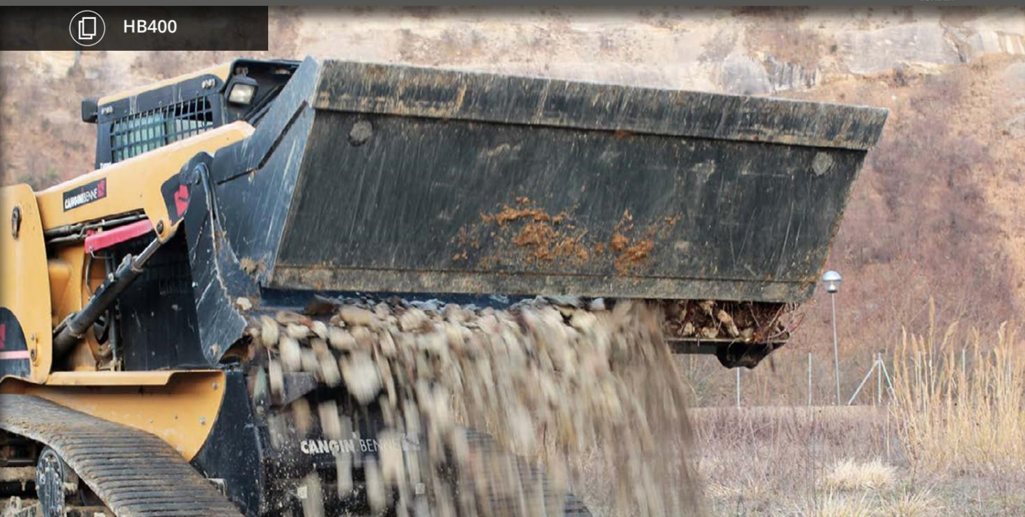
É ADATTA A OPERAZIONI DI CARICO SCARICO E MOVIMENTAZIONE. GRAZIE ALL'APERTURA IDRAULICA È ADATTA ANCHE AD AFFERRARE OGGETTI O DOSARE LO SCARICO DI INERTI E AL LIVELLAMENTO DEL TERRENO.
