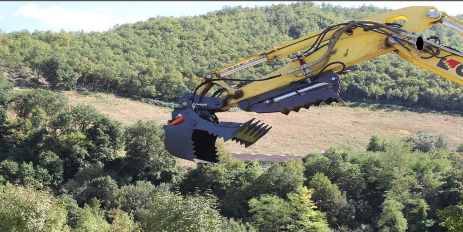
LA BENNA 4 IN 1 È UN'ATTREZZATURA MULTIFUNZIONE IN GRADO DI SVOLGERE DIVERSE ATTIVITÀ IN CANTIERE. IDEALE PER SCAVI, ATTIVITÀ DI SCARICO E CARICO. INDICATA ANCHE PER OPERAZIONI DI LIVELLAMENTO E RINTERRO. INOLTRE LA DOPPIA LAMA DENTATA LA RENDE EFFICACE PER AFFERRARE DIVERSI MATERIALI.
