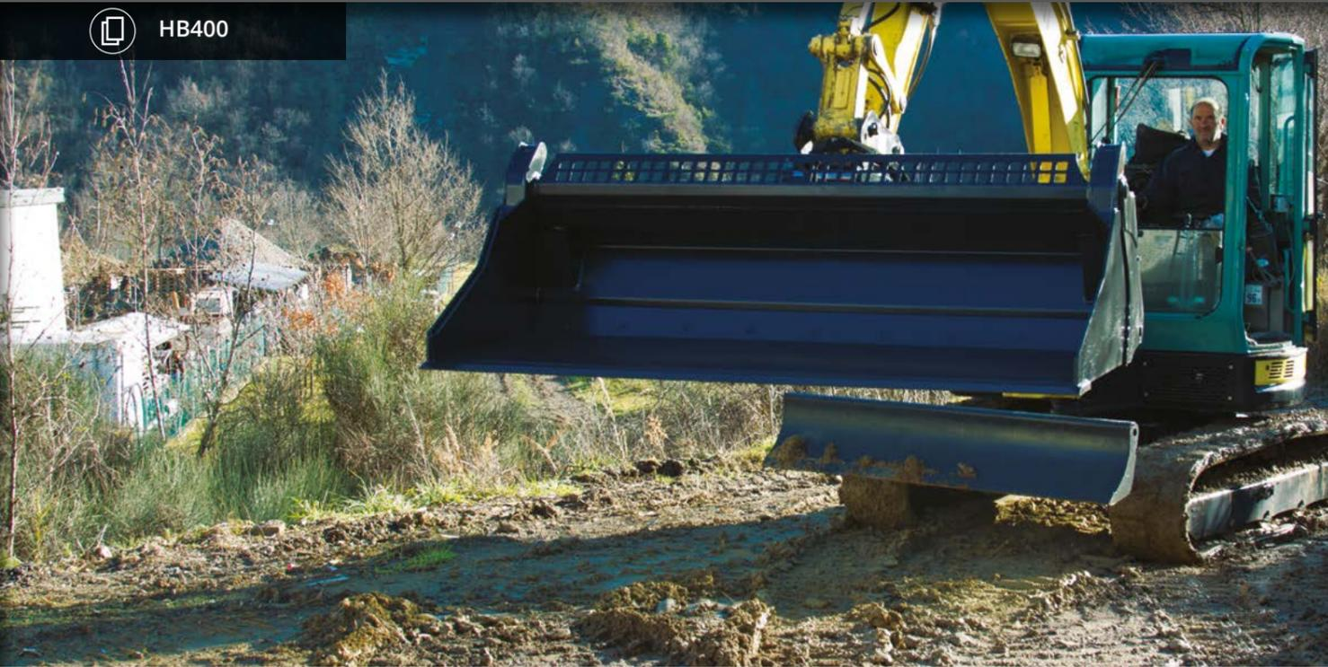
È ADATTA A OPERAZIONI DI CARICO SCARICO E MOVIMENTAZIONE. GRAZIE ALL'APERTURA IDRAULICA È ADATTA ANCHE AD AFFERRARE OGGETTI O DOSARE LO SCARICO DI INERTI E AL LIVELLAMENTO DEL TERRENO.
