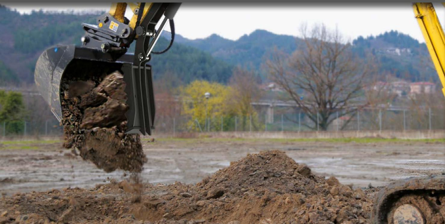
SALDATO SUL BRACCIO, IL POLLICE GRT CANGINI AGEVOLA LA PRESA DI MATERIALE ROCCIOSO, TRONCHI E MOLTO ALTRO, FUNGENDO DA PINZA. UNA VOLTA RIPIEGATO COMPLETAMENTE CONSENTE IL NORMALE FUNZIONAMENTO DELLA BENNA AGEVOLANDO IL LAVORO DELL'OPERATORE. AL MOMENTO DELL'ORDINE
