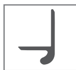
APPOGGIO A GOCCIA BOTTOM HOOK CONNECTION
