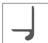
APPOGGIO A GOCCIA BOTTOM HOOK CONNECTION
