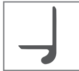
APPOGGIO A GOCCIA BOTTOM HOOK CONNECTION
