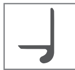
APPOGGIO A GOCCIA BOTTOM HOOK CONNECTION
